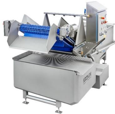
Bio- zertifizierte Lösung (D) zur Hygienisierung von Produkten und Prozesswasser: Das KRONEN CITROCID<sup>®</sup> System ist ein innovatives System zum hygienischen Waschen von ganzem Obst und Gemüse und Freshcut-Produkten und eine Alternative zur chlorbasierten Desinfektion.
