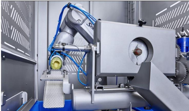
Die patentierten Werkzeuge zum Entsteinen und Halbieren sowie zum Schälen der Avocados werden in der Roboter Avocado Linie eingesetzt.
