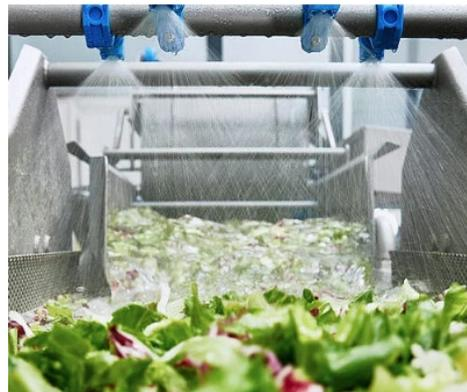
Die HELICAL-Waschmaschine HEWA 4000 ist eine Weiterentwicklung der GEWA 4000 PLUS. Sie ist optimiert im Hinblick auf Hygiene und eine reduzierte Reinigungszeit. Die HEWA 4000 verarbeitet bis zu 4 Tonnen pro Stunde.
