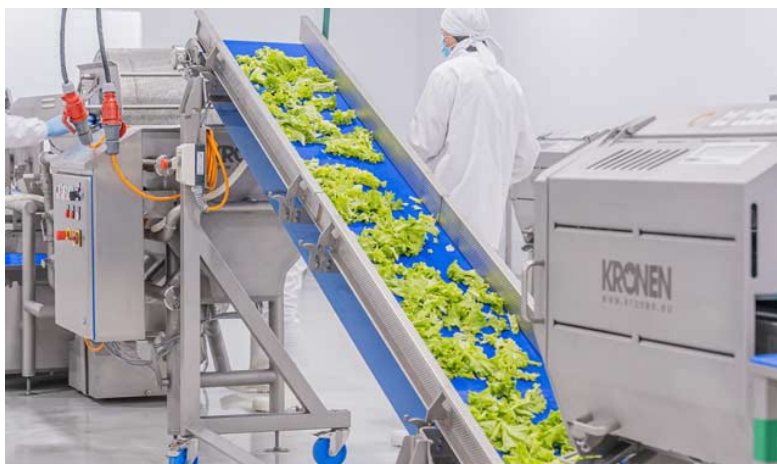
La línea de procesamiento de lechuga de Comepar incluye una cortadora de banda GS 10-2, una lavadora HEWA 3800V PLUS y dos centrifugadoras KS-100 PLUS.
