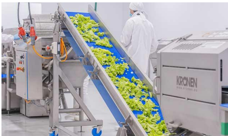
Die Salatverarbeitungslinie bei Comepar umfasst eine Bandschneidemaschine GS 10-2, eine Waschmaschine HEWA 3800V PLUS sowie zwei Trockenschleudern KS-100 PLUS.
